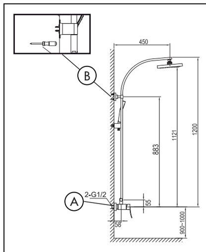
A - Dévisser les 2 vis de la barre, assembler le mitigeur à la barre, resserrer les vis après montage
